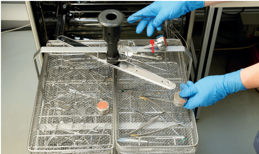
Abb 2: Spüldruckmessung während der Prozessvalidierung im RDG.
