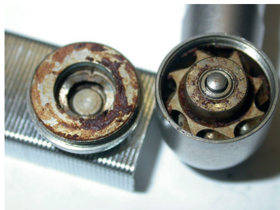
Abb. 2: Turbine mit abmontiertem Druckknopf – Rotor mit Restanschmutzung.
