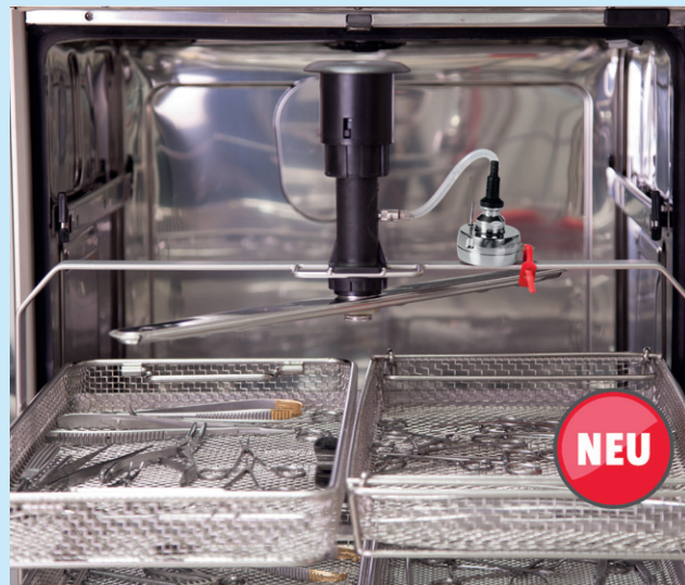
Abb. 1: EBI 12-TP237 Temperatur-/ Druckdatenlogger in Anwendung im RDG.
