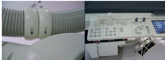
Abb. 1: Rillenzwischenräume und Schraubentiefungen sind nur schwer zu reinigen (links). Userinterface mit schwer zu reinigenden vertieften Tasten und Joysticks (rechts).
