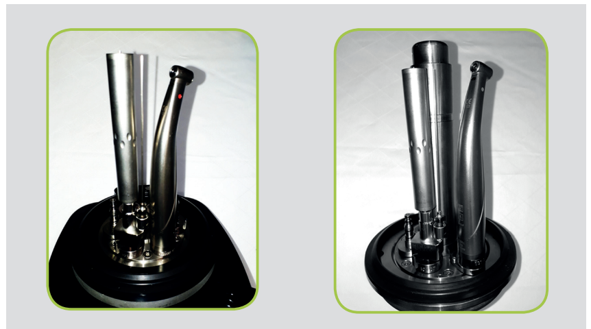
Abb. 2: Prüfadapter mit Prüfkörpern und real verschmutztes Instrument am MK IV.
