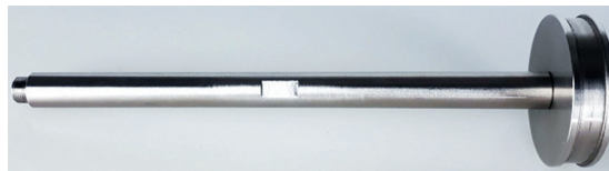
Abb. 7: Mittelsäule zur Positionierung der Datenlogger im MK IV.
